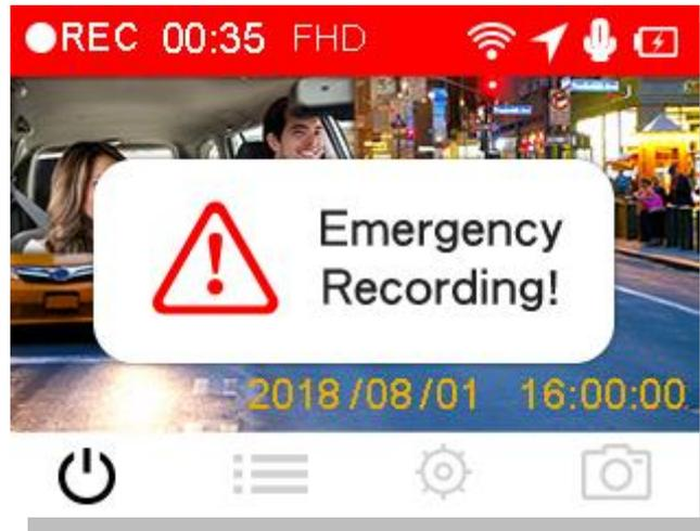
**Gravação de Evento Automática:** Durante a gravação, a DrivePro irá activar a Gravação de Emergência quando detecta uma colisão.
