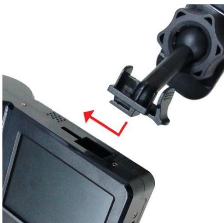
2. Limpe e seque a área do pára-brisas onde irá montar a DrivePro. Instale-a no centro do pára-brisas junto ao espelho retrovisor de forma a ter melhor campo de visão.
